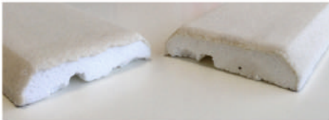
Фабричный стык (так изделие сходит со станка)
