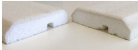
Фабричный стык зачищенный стык
