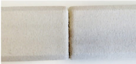
Фабричный стык (так изделие сходит со станка)
